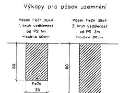
Uzemnění úsekového odpočítání
