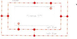
Uzemnění trafostanice DC_0403
